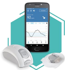
Abb. 1: GlucoMen Day® CGM bestehend aus Sensor, Transmitter, Applikator und der GlucoMen Day® CGM App.
